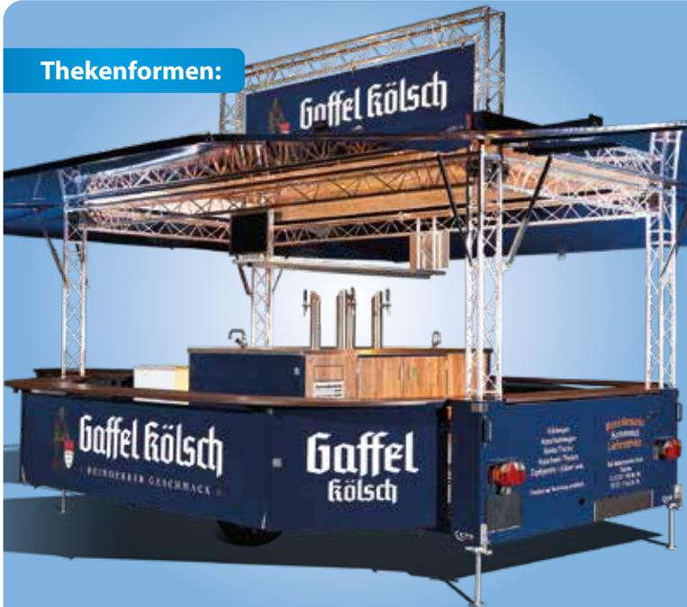
**Die Thekenbretter an den Seiten und am Heck werden während der Fahrt mit wenigen Handgriffen eingeklappt und arretiert.**
