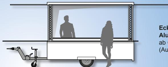
Eckstützen aus Alu-Traversen mit Quertraversen ab Oberkante Theke (Aufpreis)
